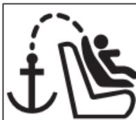
6. Следует закрепить якорный ремень (4) к точке крепления, предусмотренной в автомобиле и обозначенной символом.
