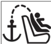
6. Připojte Top Tether (4) do ukotvovacího bodu připraveného ve vozidle a označeného symbolem.
